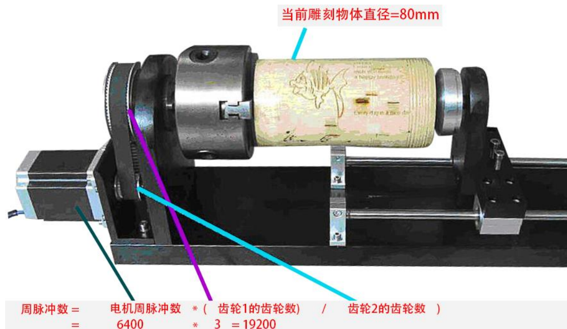
图 6-7-10 旋转雕刻切割示例图—夹具式
